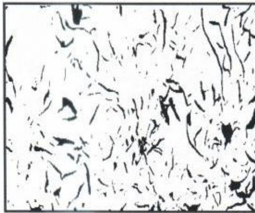
*Графитовые включения имеют пластинчатую форму*
